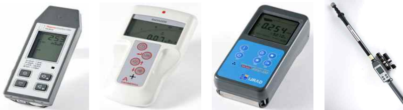
[ 그림 2-17 ] 방사선 측정기 및 원거리 측정세트
