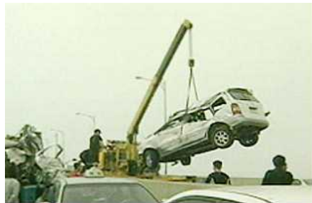
[ 그림 5-13 ] 크레인을 이용한 차량 인양
